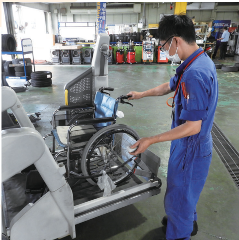
▲ 電動リフトの点検は車いすを載せて行う
